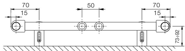
Der gelieferte Satz für die Befestigung des Heizkörpers an der Wand beinhaltet vier Stück Spezialkonsolen aus Kunststoff, Schaftschrauben, Dübel und eine Montageanleitung.
