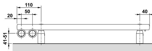
Der gelieferte Satz für die Befestigung des Heizkörpers an der Wand beinhaltet vier Stück Spezialkonsolen aus Kunststoff im Farbton Chrom, Schaftschrauben, Dübel und eine Montageanleitung.
