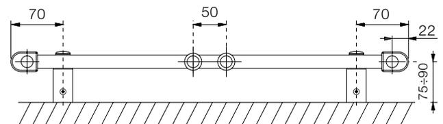
Der gelieferte Satz für die Befestigung des Heizkörpers an der Wand beinhaltet vier Stück Spezialkonsolen aus Kunststoff im Farbton Chrom, Schaftschrauben, Dübel und eine Montageanleitung.
