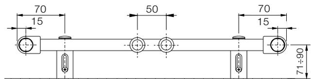
Der gelieferte Satz für die Befestigung des Heizkörpers an der Wand beinhaltet vier Stück Spezialkonsolen aus Kunststoff, Schaftschrauben, Dübel und eine Montageanleitung.
