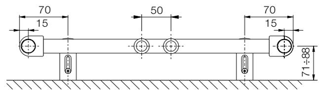
Der gelieferte Satz für die Befestigung des Heizkörpers an der Wand beinhaltet vier Stück Spezialkonsolen aus Kunststoff, Schaftschrauben, Dübel und eine Montageanleitung.
